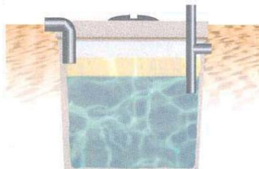
Concentración máxima de hidrocarburos a la salida de 100 mg/l.
