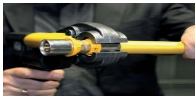
Paso 4: realizar el apriete con la prensa, utilizando mordazas tipo "TH". Se coloca la mordaza del diámetro correspondiente sobre el anillo plástico portacasquillos para fijar la posición y se realiza el apriete hasta que la mordaza está en posición totalmente cerrada.
